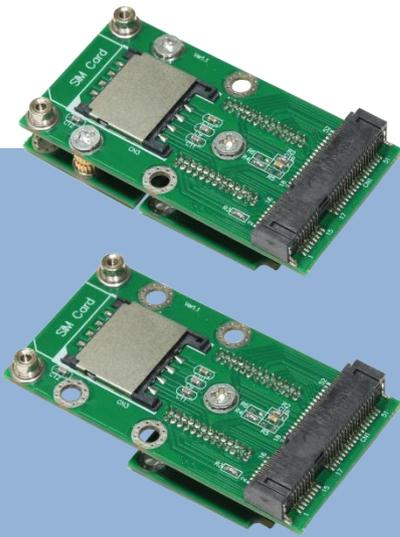
MM3U-DB3U は MiniCard 用の垂直方向エクステンダです。MM3U と DB3U と同時に利用します。
